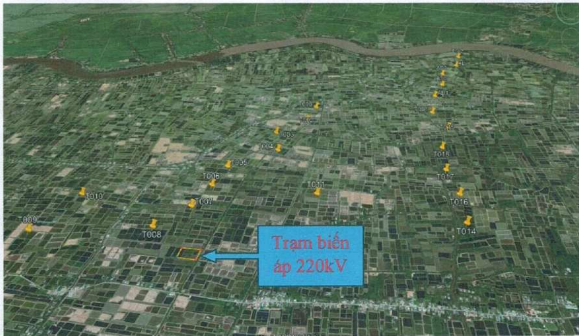
Hình 1.2: Mặt bằng bố trí tuabin của Nhà máy điện gió Hòa Đông 2
